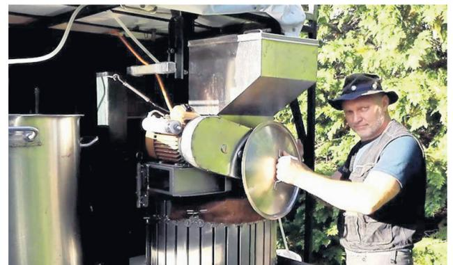
So sieht sie aus, seine selbst entwickelte und gebaute Mosterei, mit der Dennis Tilwitz bis zu 200 Kilogramm Äpfel pro Stunde zu Most verarbeiten kann.
